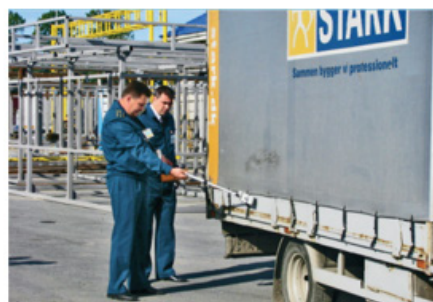
Рис. 1. Процес огляду контейнера з семи пунктів [3]: 1 – ліва сторона; 2 – передня стінка; 3 – вздовж низу; 4 – права сторона; 5 – верх; 6 – двері; 7 – низ
