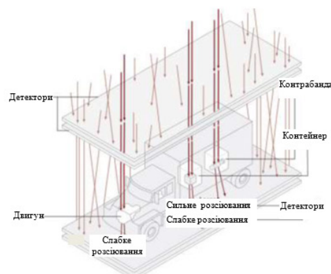
Рис. 5. Приклад геометрії детектора під час інспекції вантажу [18]
