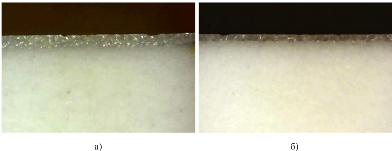
Рис. 4. Мікроструктура зламу черепка зразків: а) кухоль 1, б) кухоль 2
