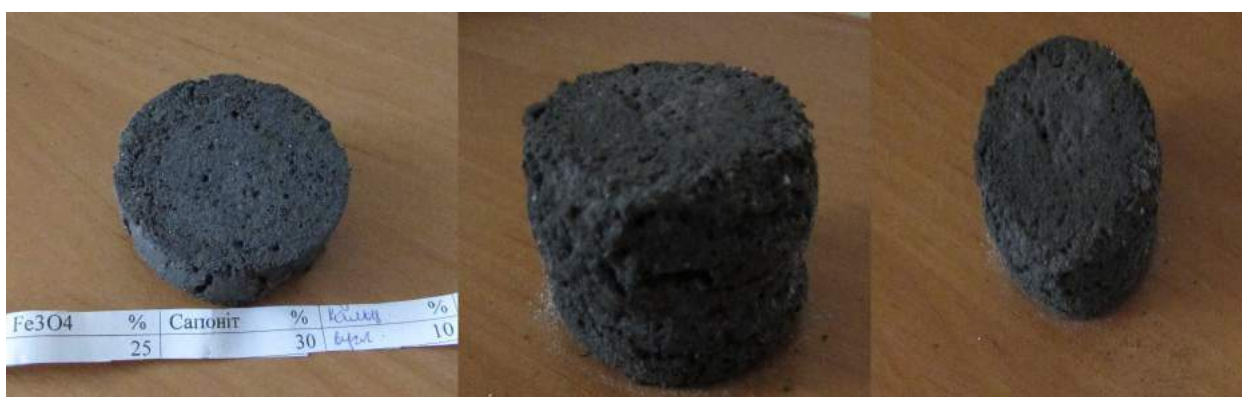
Рис. 2. Нова пориста прониклива кераміка отримана методом СВС
