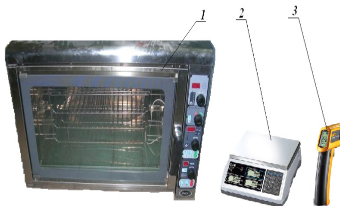
Рис. 1. Експериментальний стенд для дослідження роботи пароконвектомату: 1 – пароконвектомат, 2 – ваги, 3 – оптичний термометр
