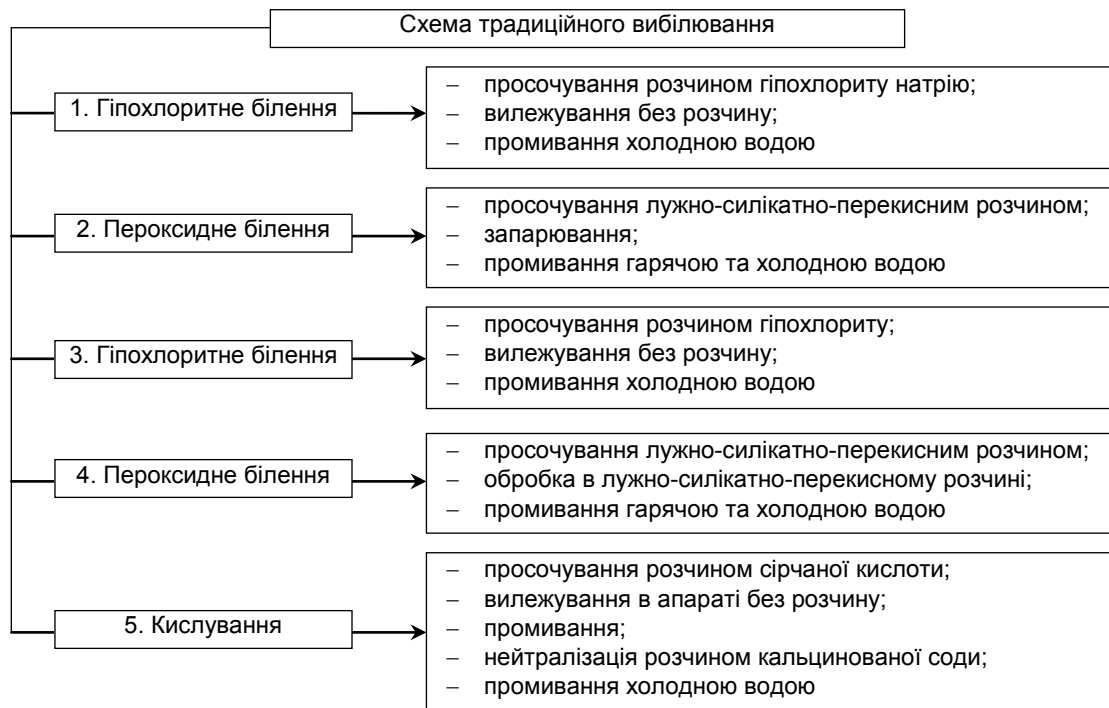
Рис. 1. Схема традиційного вибілювання лляної тканини на п'ятисекційній лінії ЛЖО-1-Л
