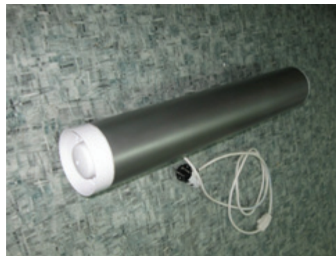
Рис. 2. Установка бактерицидного знезараження повітря рекуперативного типу УБЗП-3: площа для знезараження повітря 20–30 м 2 . Продуктивність знезараження 80–90 м 3 /год. Розміри (620×140×100); маса установки – 2 кг; потужність – 35 Вт. Установка для знезараження повітря використовують в навчальних і дитячих закладах, офісах, громадських місцях, підприємствах і т. ін.
