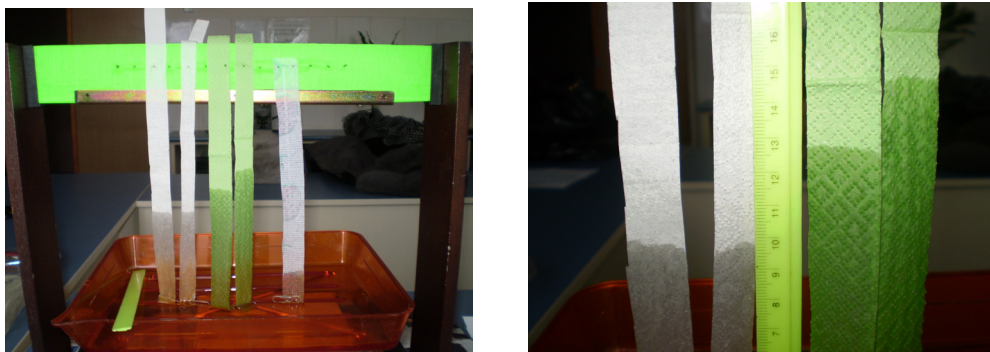
Рис. 3. Процес визначення капілярної всмоктуваності паперових серветок за методом Клемма
